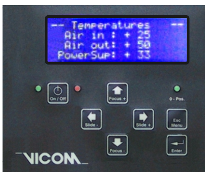
projektionen werden heute endlich möglich. Die Lüfter sind unglaublich leise. Das 4-zeilige Display dient der Information, Bedienung und zu Servicezwecken auf Vorder- sowie Rückseite des Dias
