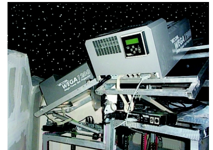
Zwei WEGA 1200 Projektoren bei einer Festinstallation in einem Planetarium.
