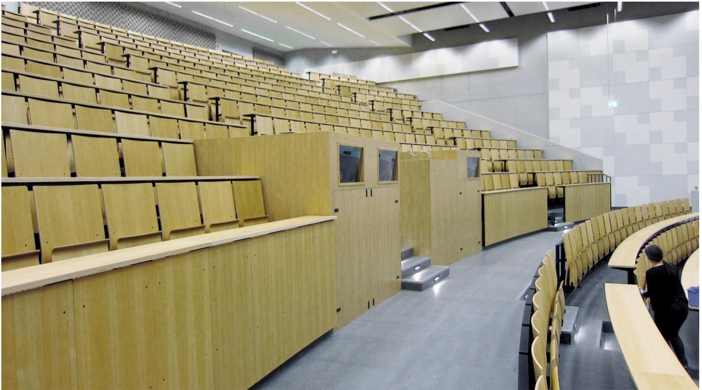
Hier sehen Sie Schallschutzgehäuse in einem Hörsaal einer Universität. Drei unabhängige Projektionssysteme (siehe die entsprechenden Projektionsfenster) wurden in die vom Kunden vorgegebene Möbelserie integriert. Die Projektoren sind auf Schienensystemen installiert, um im Bedarfsfall z.B. einen schnellen Lampentausch zu ermöglichen. Aufgrund der leicht kurvigen Anordnung der Sitze waren die Anforderungen an die Präzision der Arbeit der Schreiner sehr hoch.
