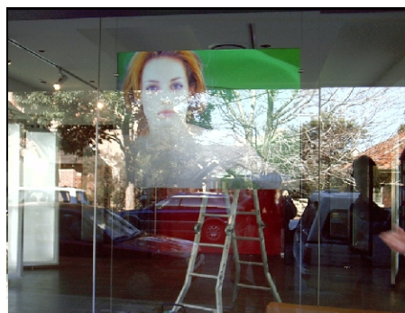
Direktvergleich einer Schaufensterprojektion in der Praxis Links ohne Antireflex-Coating .
